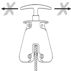
Insérer entièrement la charge dans les mâchoires de serrage.
