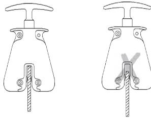
Das Gerät selbst darf keinesfalls als Tragmittel zum Anschlagen von Seilen, Ketten oder Bändern verwendet werden.
