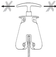
Das Hebegut muss immer bis zum Anschlag aufgeschoben werden.
