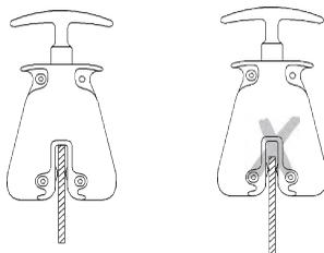
L'appareil lui-même ne doit jamais être utilisé pour attacher des câbles, chaînes ou sangles.
