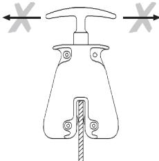
Inserte siempre la carga hasta el final en la boca de la garra.
