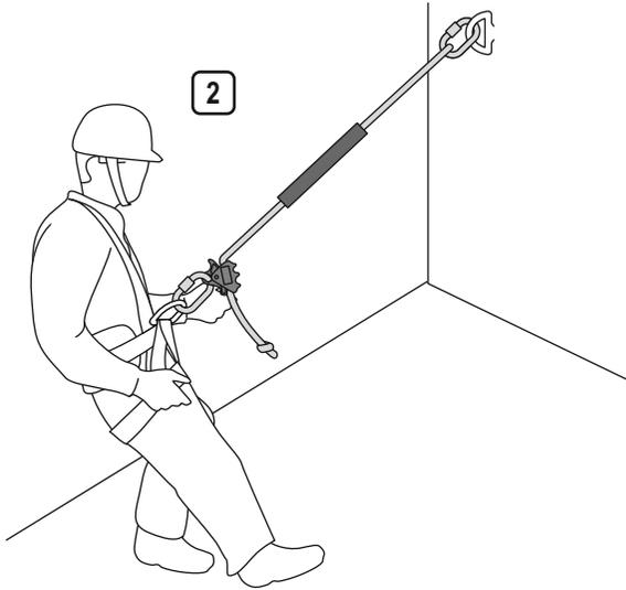
3. À l'aide du régulateur, adapter la longueur de la corde de manière à obtenir une position de travail stable. La corde doit être tendue pendant le travail avec le dispositif.
