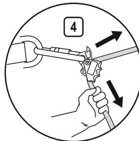
**ACHTUNG:** Überprüfen Sie vor und während der Arbeiten die Festigkeit der Verbindung zwischen den einzelnen Verbindungselementen. Die Verbindungselemente müssen geschlossen und durch einen Verriegelungsmechanismus gegen unbeabsichtigtes Öffnen gesichert sein.
