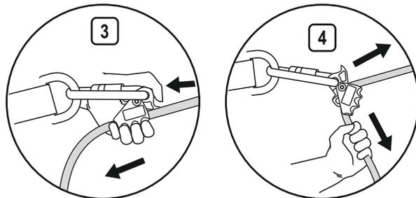
LET OP: Vooraleer met werk wordt begonnen en tijdens werk dient men zeker te zijn dat de verbindingen tussen de afzonderlijke haakelementen stabiel zijn. De karabijnhaken moeten gesloten zijn en tegen toevallig openen beveiligd.
