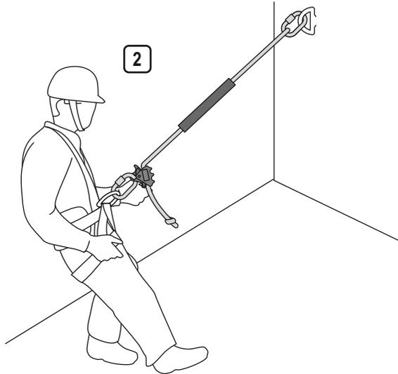
3. Mithilfe des Verstellers die Seillänge so einstellen, dass eine stabile Arbeitsposition erreicht wird. Bei Arbeiten mit dem Gerät muss das Verbindungsmittel gespannt sein.
