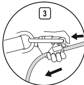
(b) Kürzen des Verbindungsmittels des Gerätes
