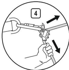
**ATTENTION :** Avant de commencer le travail et au cours du travail, il faut vérifier la durabilité des raccords entre les différents éléments d'attache. Les connecteurs doivent être fermés et protégés contre toute ouverture accidentelle à l'aide d'un mécanisme de blocage.
