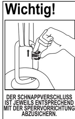
Der Bandhaken AZ 700 darf auf Elemente der stationären Konstruktion (eines Trägers), die aus Beton oder aus Stahl angefertigt sind und die verschiedene Formen aufweisen, angelegt werden.
